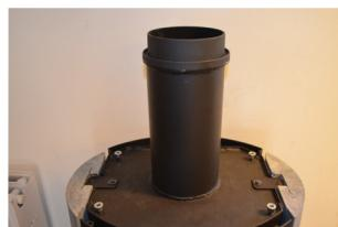
**5:** Ved ønsket topoprør, fjern støpejernsstussen på toppen av ovnen og monter det medfølgende røret – husk pakningen mellom ovnen og røret. Støpejernsstussen monteres igjen på toppen av røret – husk pakningen mellom røret og bolten.
