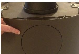
**6:** Ønskes bagudgang, så afmonter støbejernsstudsens på toppen af ovnen. Pladerne bag på yderkappe og varmeskjold brækkes forsigtigt ud. Dækpladen, der er monteret på ovnen, afmonteres (skal tages ud gennem brændkammeret) og monteres efterfølgende på toppen af ovnen i stedet for støbejernsstudsens. Støbejernsstudsens monteres på bagsiden af ovnen. Husk pakning.
