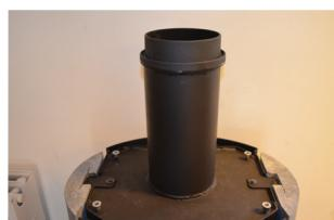
**5:** Jos haluat savuputken takan päälle, poistaa sen yläosassa oleva valurautainen holkki ja asenna aukkoon mukana tullut putki – muista sijoittaa tiiviste putken ja takan väliin. Valurautaholkkia asennetaan mukana toimitetun savupiippuputken yläosaan – muista asettaa tiiviste holkin ja savuputken väliin.
