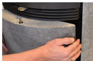
**23:** Monter de 2 stk. medfølgende pakninger på undersiden af fedtstenen. Rengør først stenen, der hvor påkningen skal klæbes fast. Fjern plastprop i bunden af ovnen.
