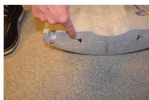
**11:** Monter nå den bakerste klebersteinen (Merk: Front- og baksteinen er identiske, så hvis du synes at den ene er «penere» enn den andre, så monterer du den «penere» på fremsiden og den andre på baksiden). I underkant av steinene er det fire hull som skal passe ned i de fire tilsvarende styrteappene på stålplattformen.
