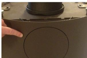
**6:** Önskas bakutgång, ska du avmontera gjutjärnsstudsens på toppen av kaminen. Plattorna bak på ytterkappa och värme-sköld bryts försiktigt ut. Täck-plattan som är monterad på kaminen avmonteras (ska tas ut genom brännkammaren) och monteras därefter på toppen av kaminen i stället för gjutjärnsstudsens. Gjutjärnsstudsens monteras på baksidan av kaminen. Kom ihåg packning.
