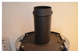
**5:** Önskas toppavgång ska du avmontera gjutjärnsstudsen på toppen av kaminen och montera det medföljande röret – kom ihåg packning mellan rör och kamin. Gjutjärnsstudsens monteras därefter på toppen av det medföljande rökröret – kom ihåg packning mellan rör och studs.
