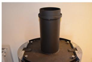
**5:** Ønskes topafgang så afmonter støbejernsstudsens på toppen af ovnen og monter det medfølgende rør - husk pakning mellem rør og ovn. Støbejernsstudsens monteres herefter på toppen af det medfølgende rør - husk pakning mellem rør og studs.
