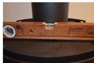
**7:** Kontroller at ovnen er i vatter. Monter/juster om nødvendigt de 4 stillefødder under selve ovnen, så den står stabilt og sikkert på underlaget. **BE-MÆRK!** Der skal være min. 8 mm luft under ovnen så fremt der ønskes at montere en TermaTech formskåret glasplade.
