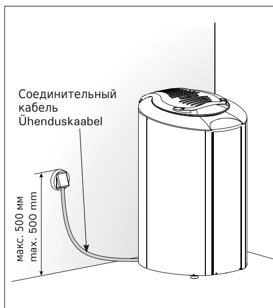
Рис. 11. Установка каменки Joonis 11. Kerise ühendamine
