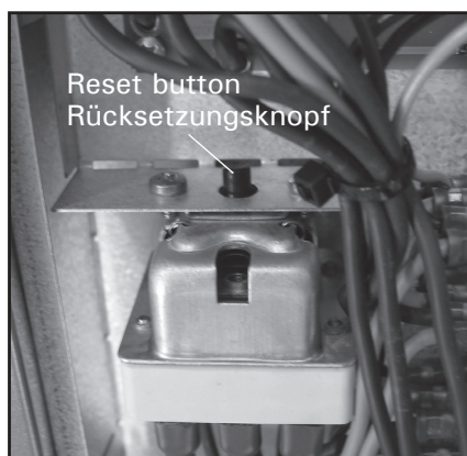
Figure 3. Overheat protector Abbildung 3. Überhitzungsschutz
