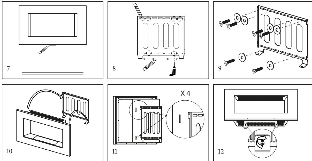
auf. Bei korrekter Platzierung arretieren sowohl die oberen als auch die unteren Haken in der Wandbefestigung (Abb. 10-11). Prüfen Sie auf beiden Seiten nach, dass die oberen und die unteren Haken korrekt platziert sind (Abb. 11). Wichtig! Wenn sich die Haken nicht in korrekter Position befinden, besteht die erhöhte Gefahr, dass der Kamin bei äußerer Einwirkung herunterfällt. Überprüfen Sie dies also sehr sorgfältig.
