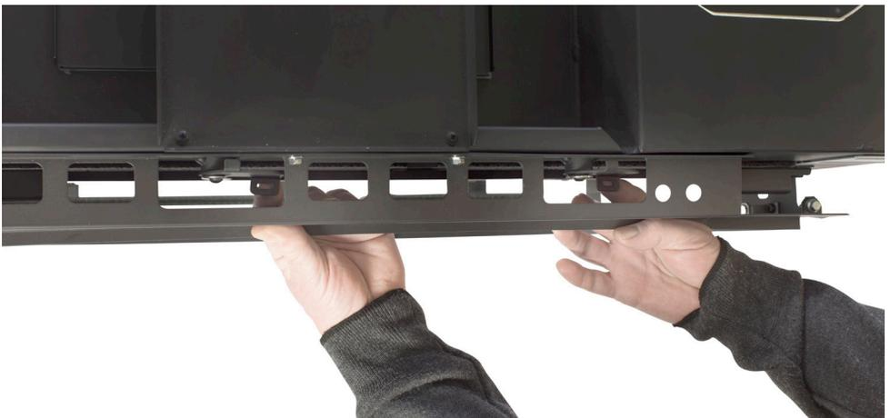
3. Die Glasscheibe an den beiden Metallkanten oben an der Glasscheibe zur Front hin herausziehen.
