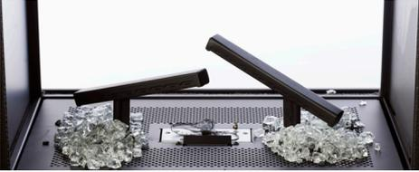
4. Strö ut glödbädden (både de grå och de svarta delarna) över både glaspärlorna och bottenplattan med hål. Var noggrann med att inte täcka pilotområdet och hålen i det.
