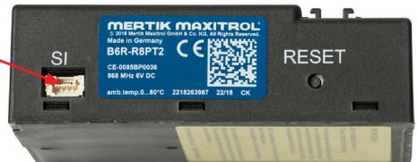
Der breite Stecker an der Wi-Fi-Leitung wird in die Wi-Fi-Box gesteckt.
