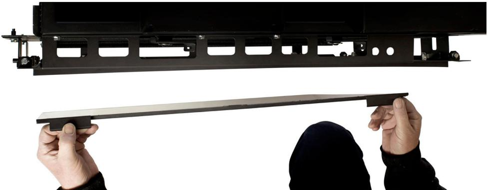
Når glasset skal monteres igen, følges de fem trin i omvendt rækkefølge. OBS! Der sidder en kile midt på gaspejsens ramme, der sikrer, at glasset monteres korrekt. Denne kile skal passe ind mellem de to indhak på glasset. Det er meget vigtigt, at dette gøres korrekt, ellers slutter ovnen ikke tæt, og der kan forekomme soddannelse under brug. Se fremgangsmåde nedenfor.
