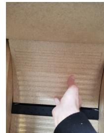
**3:** L'espace vous permet de soulever la vermiculite arrière supérieure (courbée) au-dessus de la régllette d'arrivée d'air.
