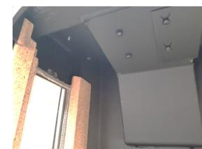
**6:** Løsne de 4 unbraco skruer med en 4mm unbraco nøgle. Se Photo 6a.
