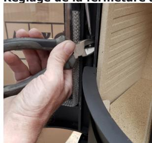
Enlevez la goupille et serrez la vis (dans le sens de l'aiguille d'une montre) en fonction de la vitesse de fermeture souhaitée.
