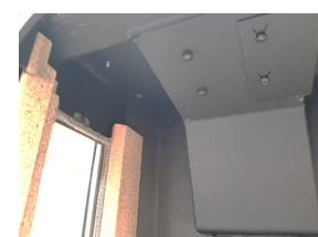
**6:** Løsne de 4 unbra-koskruene med en 4mm unbrakonøkkel. Se bilde 6a. Metall røyplater 1 og 2 skyves litt tilbake og kan deretter fjernes. Ovnen er nå klar til rengjøring.
