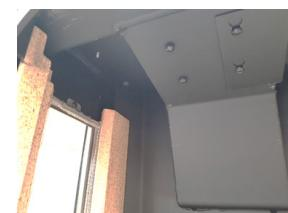
**6:** Dévissez les quatre vis à 6 pans avec une clé 4mm. Voir photo 6a. Les déflecteurs 1 et 2 peuvent ensuite être reculés pour les enlever. Le poêle est maintenant prêt pour le nettoyage.
