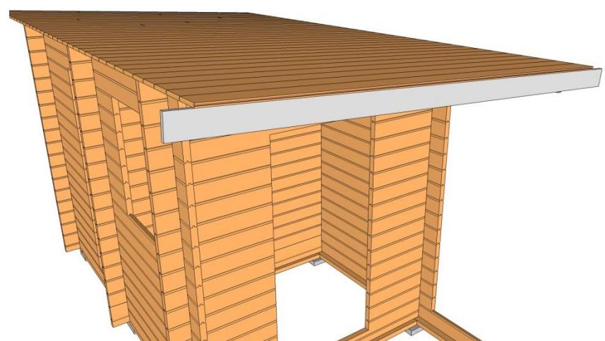
Skruba fast de övre vindbrädorna. Förskjut vindbräden ca 5-7cm uppåt.
