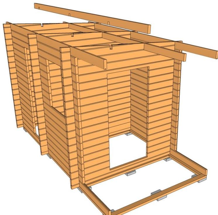
Montera taket. Lägg brädorna med finsidan inåt.
