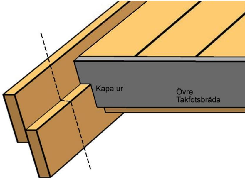
Bild på hörn mot högsta punkt på tak. Kapa till som vid takfoten men dra upp övre bräden till samma höjd som vindbräden på gavel.
